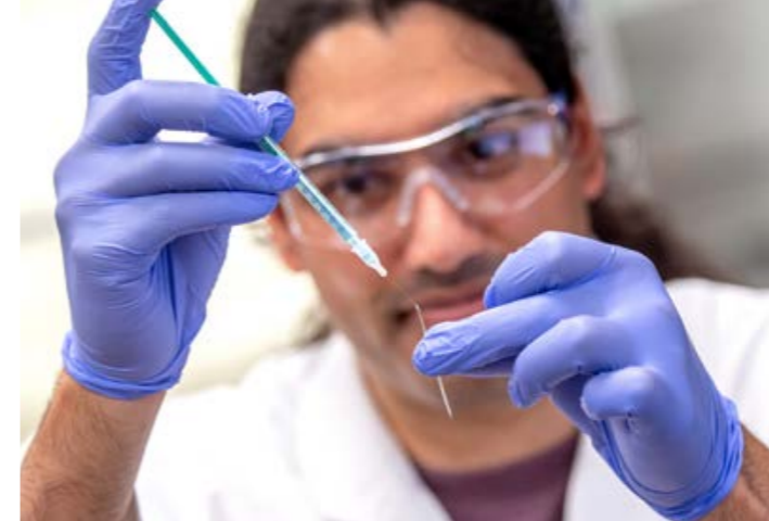
Karuna Kanes füllt flüssige Kupferlösung in die Düse und fügt anschließend einen hauchdünnen Draht – die Anode – hinzu.
