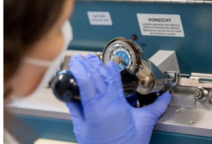
Die winzigen Druckdüsen aus Spezialglas präpariert Liaison Khasanova mit einem sogenannten Mikropipettenzuggerät.
