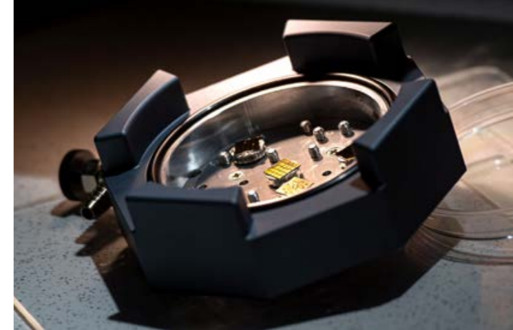
Gedruckt wird auf goldbeschichteten Siliziumplättchen, kleiner als ein Fingernagel. Sie dienen gleichzeitig als Kathode.
