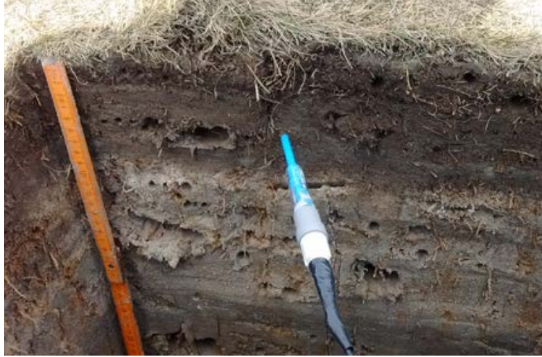
Messungen des Redoxpotenzials zeigen, ob aerobe oder anaerobe Bedingungen im Boden vorherrschen.
