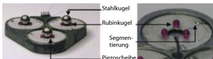
Abb. 2 (links): Aufbau der mobilen Plattform.
