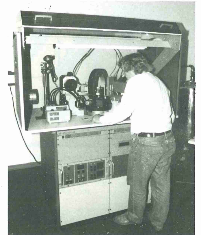
Mit dem Einkristalldiffraktometer werden die Kristalle untersucht.
